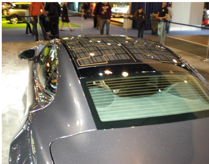
Taget er beklædt med solpaneler, som yder 0,5 kWh pr.dag. Der kan vælges om strømmen skal gå til oplading af batterierne eller til køling af kabinen
